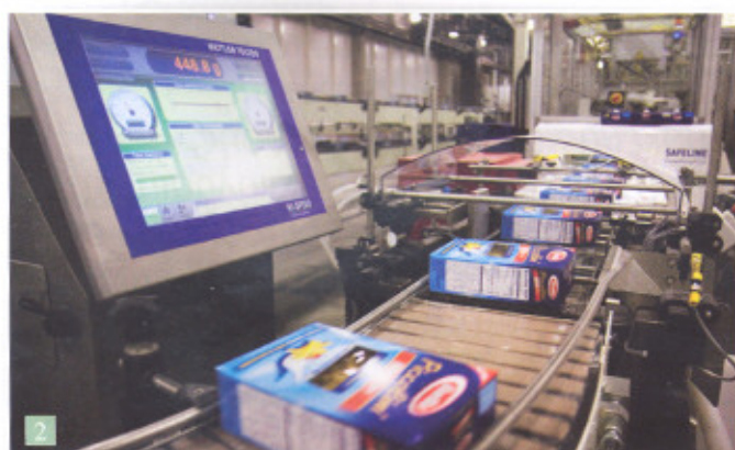
Ρομποτικό σύστημα για την αυτόματη παλετοποίηση συσκευασιών (1) και έλεγχος ζύγισης με υψηλή ακρίβεια (2). Πηγή: Όμιλος Θεοδώρου
