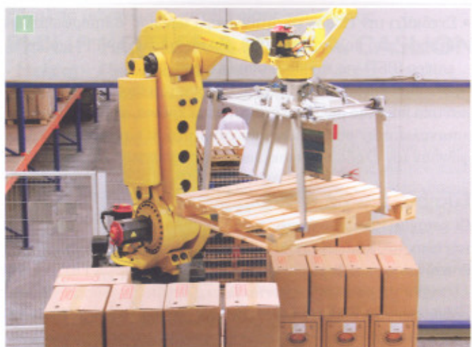
Ρομποτικό σύστημα για την αυτόματη παλετοποίηση συσκευασιών (1) και έλεγχος ζύγισης με υψηλή ακρίβεια (2). Πηγή: Όμιλος Θεοδώρου
